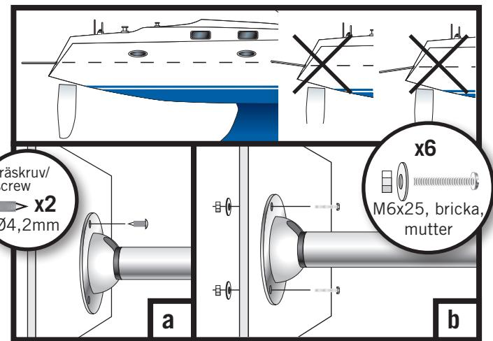
3: Fäst plattformen provisoriskt med en självgående skruv (a) i ett av hålen, fixera plattformen mot akter med hjälp av lina i pulpit. Flukta in linjen mot skrovet och däck så att plattformen hamnar rakt. Fäst universalbeslagen med bultar (b) i skrovet. Ta bort skruven (a) och fäst sista bulten i varje beslag. Täta med Sikaflex.
