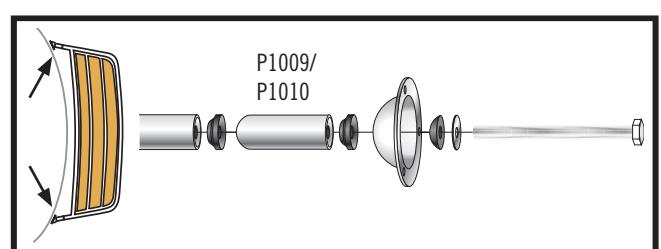
Förlängning + 50 mm finns att beställa. P1009 (Ø25 mm), P1010 (Ø32 mm). Eventuellt måste stagen(B) under plattformen bytas till ett längre (vid rak akter). Finns att beställa: P1032 (350 mm).
