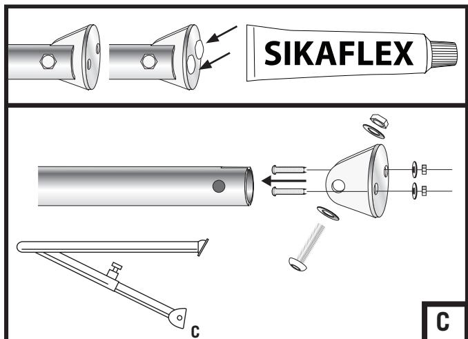
4: Fäst u-beslagen och markera med penna direkt i hålen på u-beslagen där fästhålen skall borras i akterspeglens. Skruva åt teleskopstagen ordentligt.
