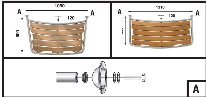
1: Kontrollera att alla delar finns med. Fäst universalbeslagen på plattformen. Skruva fast lagom så att de kan justeras mot akterspeglens.
