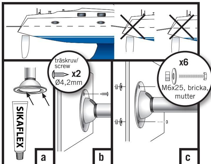
3: Fäst plattformen provisoriskt med en självgående skruv (a) i ett av hålen, fixera plattformen mot akter med hjälp av lina i pulpit. Flukta in linjen mot skrov och däck så att plattformen hamnar rakt. Fäst universalbeslagen med bultar (b) i skrovet. Ta bort skruven (a) och fäst sista bulten i varje beslag. Täta med Sikaflex.
