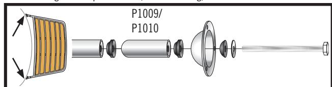
Förlängning + 50 mm finns att beställa. P1009 (Ø25 mm), P1010 (Ø32 mm).
